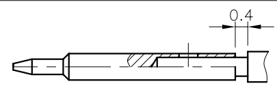
CABLE Conductor + PIN 조립 후 간격
